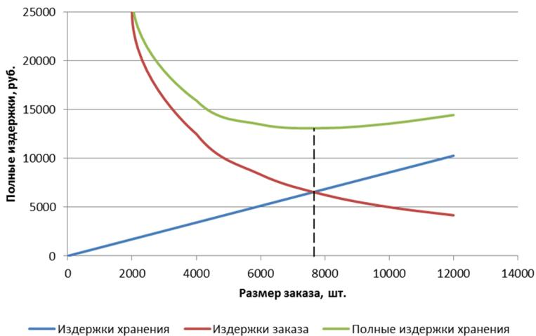
Рис. 28. Зависимость полных издержек от размера заказа
