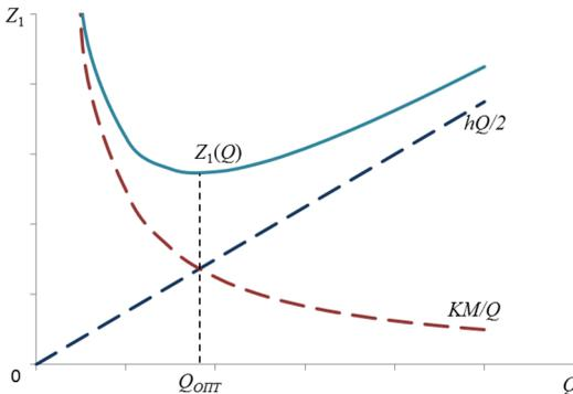
Рис. 25. График зависимости, отражающий поиск оптимального размера партии
