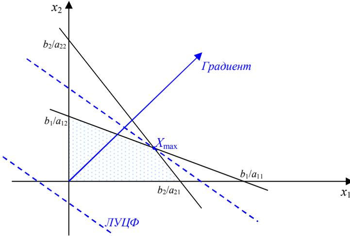
Рис. 3. Ограниченная область допустимых планов
