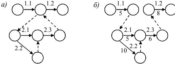
Рис. 18. «Сшивание» частных графиков
